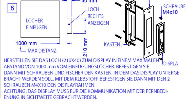
HERSTELLEN SIE DAS LOCH (210X40) ZUM DISPLAY IN EINEM MAXIMALEN
