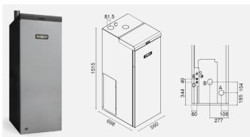
A = Ø 80 mm Scarico fumi / Flue / Cheminée / Rauchabzug / Evacuación de humos / Odvod dimnih plinov
