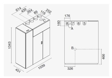
A = Ø 80 mm Scarico fumi Flue / Cheminée / Rauchabzug Evacuación de humos / Odvod dimnih plinov
