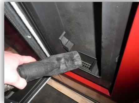
Attention : pour le nettoyage du poêle, utiliser exclusivement un chiffon sec. Ne pas utiliser de matériau abrasif ou de produits susceptibles de corroder ou de blanchir les surfaces. À la fin de la saison, lors dernier allumage, les granulés résiduels dans la vis sans fin doivent tous être brûlés. La vis sans fin doit rester vide pour éviter son colmatage par les résidus de sciure solidifiée à cause de l'humidité.
