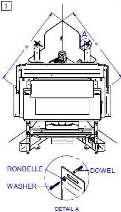
MAKE SURE THAT DISTANCE BETWEEN BRACKET AND WALL CORNER IS THE SAME ON BOTH SIDES.
