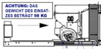
DIE SCHRAUBEN A,B,C,D WIE ANGEZEIGT ABSCHRAUBEN, UM DEN EINSATZ VON DEN FÜHRUNGEN ZU ENTFERNEN. ES EMPFIEHLT SICH, EIN KABEL ZU VERWENDEN, UM DEN EINSATZ ZU UNTERSTÜTZEN. DANN DIE PLATTE BEFESTIGEN UND DEN EINSATZ WIEDER AUF DEN FÜHRUNGEN ANBRINGEN UND NEU POSITIONIEREN.
