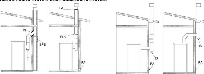
Legende: IS - Isolator; ISPE - Inspektion; T - T-Stück; FLA - Flansch mit hermetischem Verschluss; PA - Außenlufteinlass
