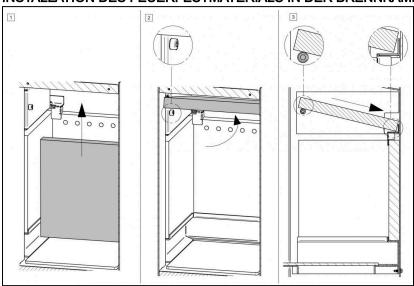
Bei EVSL5 und EVSL6 installieren Sie das obere Vermiculit auf diese Weise:
