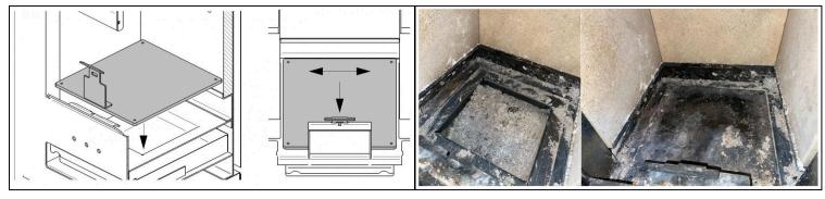
Saugen Sie die Feuerplatte mit einem Aschesauger ab oder entfernen Sie die Asche mit einer Bürste, um eine ordnungsgemäße Verbindung zu gewährleisten. Saugen Sie Asche ab, die sich im vorderen Primärluftschlitz oder in den 3 vorderen Löchern verfangen kann.
