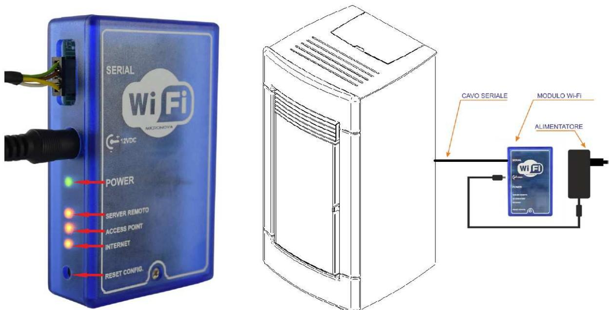
1. Connecter le module wifi à l'alimentation avec le kit transformateur en dotation
