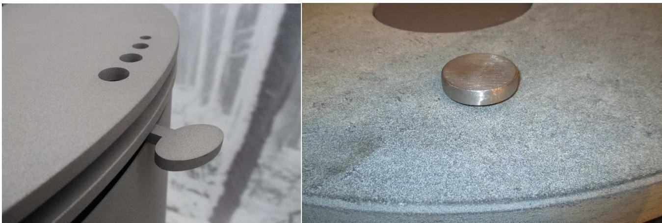
Pour le poêle 8.5kw il est impossible de régler la combustion avec l'arrivée d'air secondaire car il n'y en a pas. Le seul moyen est de régler et agir sur l'amenée d'air primaire se trouvant sur la porte du foyer.
