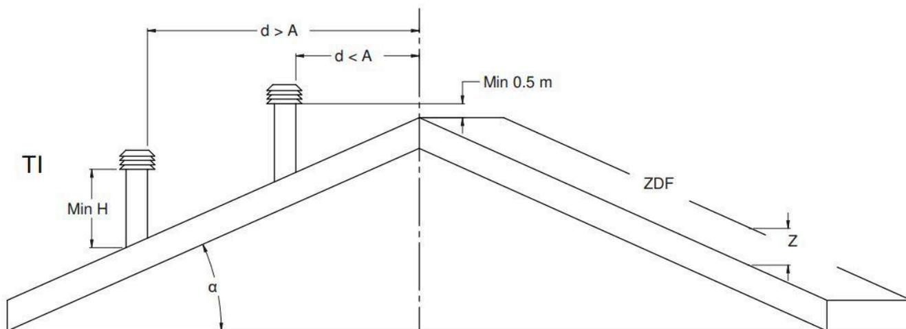
Legenda: TP - telhado plano; TI - telhado inclinado; d - distância; ZDF - zona de refluxo
