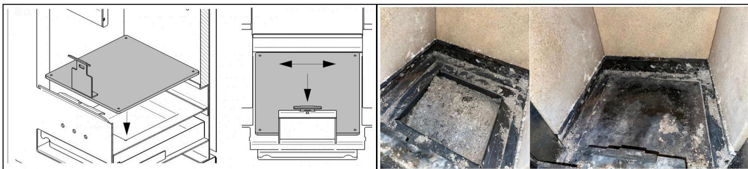
Aspirar o plano de fogo com um aspirador de cinzas ou eliminar as cinzas com um pincel, de modo a garantir o acoplamento correto. Aspirar as cinzas que podem ficar bloqueadas na fenda anterior do ar primário ou através dos três furos anteriores.
