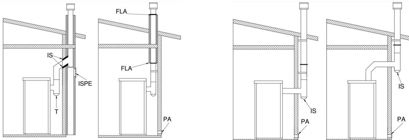
Legenda: IS - Isolante; ISPE - Inspeção; T - Conexão em T; FLA - Flange de fechamento hermético; PA - Entrada de ar externo
