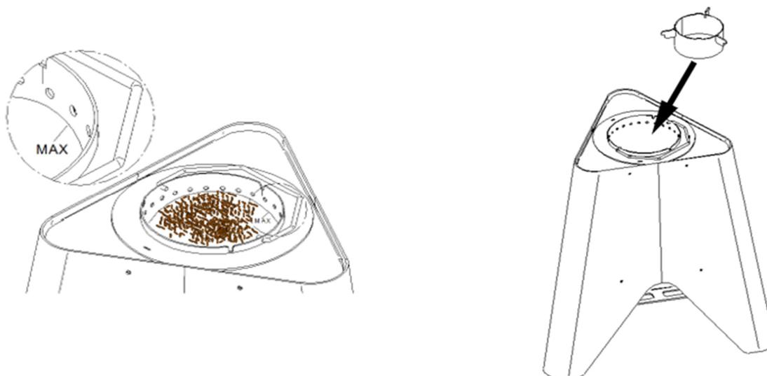
2. Riempire al massimo con pellet di legno, arrivando sotto i fori del bruciatore. Inserire nell'apposita sede l'anello fiamma.
