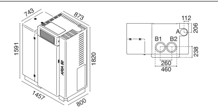
A = Ø 150 mm Scarico fumi superior / Upper fume outlet / Sortie de Haud de Fumée / Top Abgasstutzen / Salida humos superior / Descarga de fumos superior B1 – B2 = Ø mm Hot air outlet
