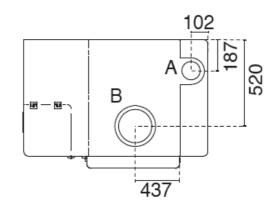
A = Ø 100 mm Scarico fumi superiore / Upper fume outlet / Sortie de Haut de Fumée / Top Abgasstutzen / Salida humos superior / Descarga de fumos superior B = Ø 200 mm Hot air output
